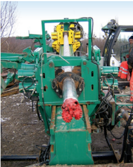
Fig. 8. Bit/rock bit for the pilot drilling. Bild 8. Bohrkronen/Rollenmeißel für die Pilotbohrung.
