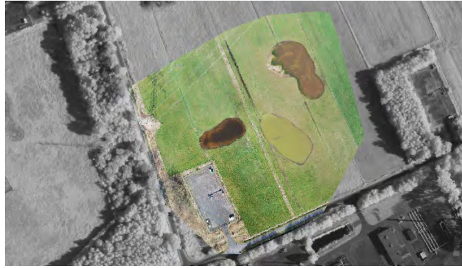
Figura 16: Foto aérea tomada con una cámara de 13MP del Yuneec Mantis Q. La imagen se calculó a partir de 43 imágenes individuales con el software para formar una imagen compuesta y se superpuso a una Ortofoto digital del estudio topográfico de NRW (Renania del Norte). (Autor Dipl.-Ing. Benjamin Haske, Forschungszentrum Nachbergbau de THGA Bochum; Fuente de la imagen Ortofoto: Geobasis. NRW https://www.wms.nrw.de/geobasis/wms_nw_dop ).
