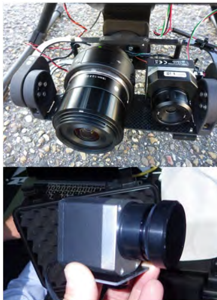
Figura 11: Cámaras termográficas aptas para dron FLIR Vue Pro R con TeAx Thermal-Capture Grabber (izquierda en comparación con una cámara SONY QX1-RGB) y OPTRIS PI Lightweight (derecha). Ambas cámaras pesan alrededor de 100 g y ofrecen una resolución óptica de 640x512 píxeles, a través de la cual son capaces de obtener datos radiométricos mediante el ThermalCapture Grabber.
