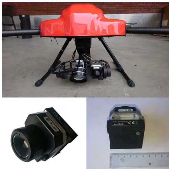
Figura 3: Configuración de vuelo en el proyecto MRM (y otros): Arriba, Drones de inteligencia artificial MC4 (adaptado) con un FLIR Vue Pro R y el TeAx ThermalCapture Grabber para una sola captura de imagen del flujo de vídeo.
