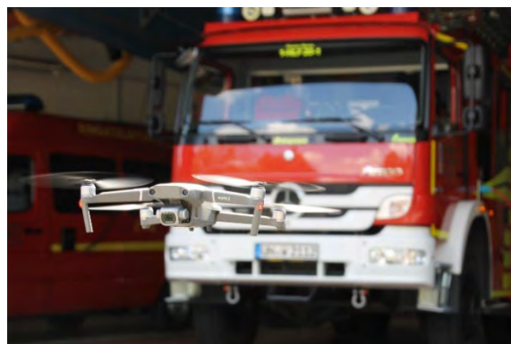
Figura 6: Dron plegable DJI Mavic 2 Pro con chip CMOS de 1 pulgada y resolución de imagen geométrica de 20 MP (Bomberos de Werne).
