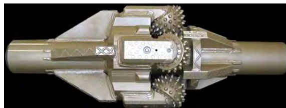
Figura 6: Ensanchador de pozos en roca maciza (Hole Opener).
