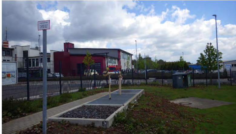
Figura 10: Instalación de pruebas de incendios por gas del Cuerpo Profesional de Bomberos de Dortmund.
