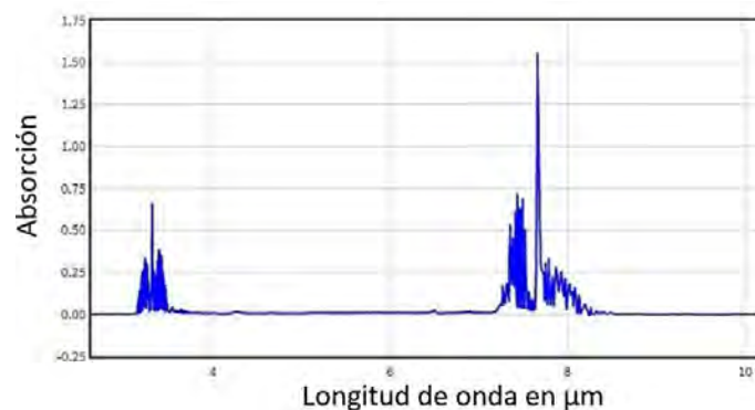
Figura 8: Espectro de absorción del metano ( CH_4 ) en fase gaseosa (23, editado).
