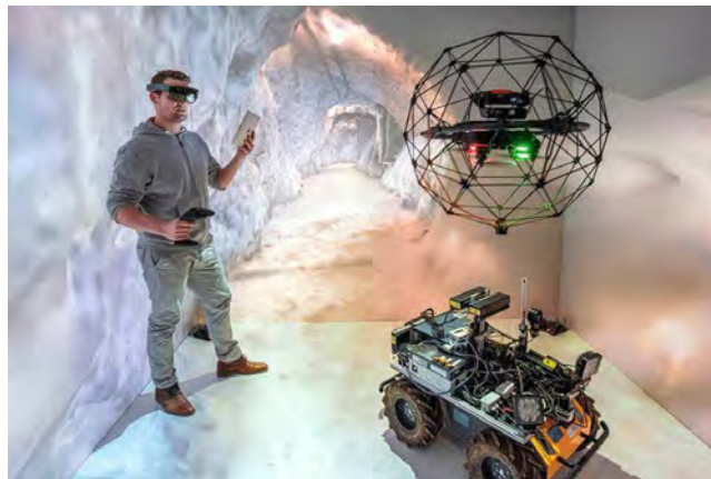
Figura 18: El dron del proyecto UNDRROMEDA está equipado con varios sensores y protegido por una jaula diseñada para amortiguar las colisiones con la roca circundante. Los vuelos de prueba en la mina de investigación y formación Reiche Zeche se muestran en un vídeo de YouTube ( https://youtu.be/1uk46ZkkejE ; Technische Universität Bergakademie de Freiberg (Universidad Técnica de Freiberg)).
