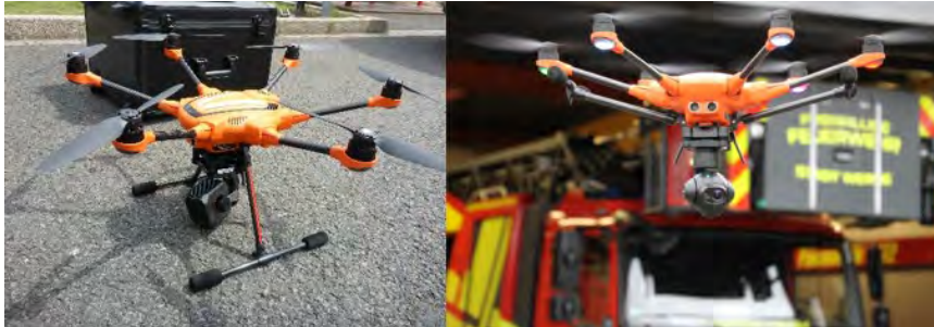
Figura 4: Hexacóptero Yuneec H520 con cámaras combinadas de imagen termográfica y luz residual; Izquierda: Cuerpo Profesional de Bomberos de Dortmund con E10T; Derecha: Cuerpo de Bomberos Voluntarios de Werne con CGO-ET.
