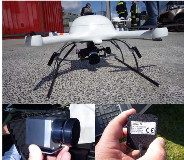
Figura 2: Configuración de vuelo en el proyecto BigGIS: Arriba, el cuadricóptero Operator I de Sitebots con una cámara IR Optris PI Lightweight.
