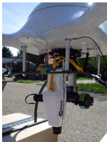
Figura 9: Cámara hiperespectral Cubert 185 UHD Firefly montada en un dron.
