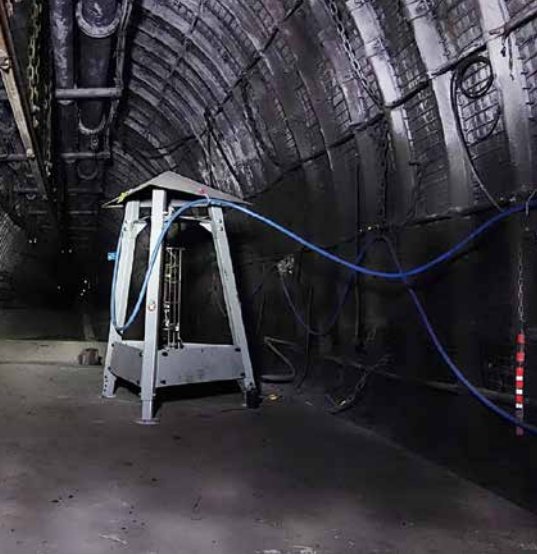
Abb. 10: Modifizierte Tiefseesonde zur Aufzeichnung des Grubenwasseranstiegs (Foto: RAG Aktiengesellschaft, Markus Schneider, Martin Justa).
